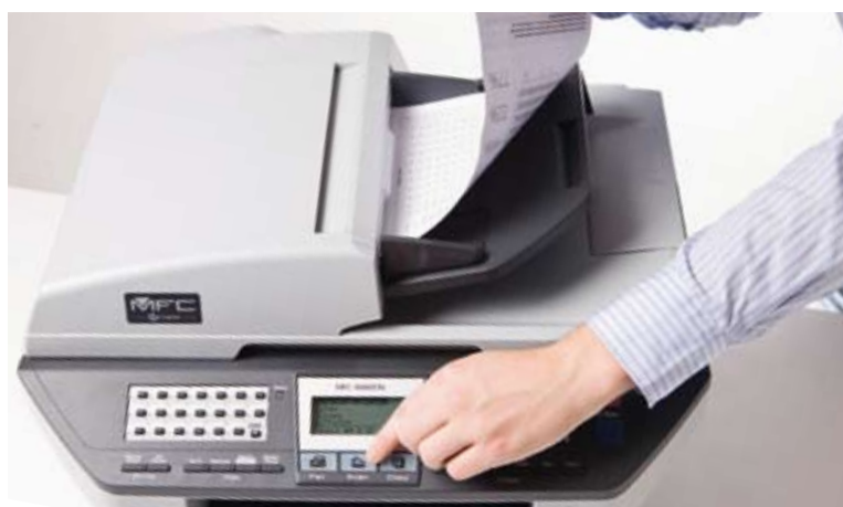
ADF – Ideale per gestire documenti composti da più pagine in fase di copia, scansione o di invio di fax.
